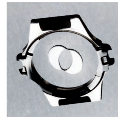
Auf einer Makino EDAF2 erodierpolierte Kavität für das Spritzen von Uhrengehäusen.
