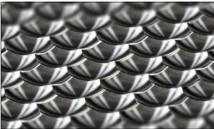
Detailansicht einer Linsenform mit einer Profilgenauigkeit von  $0,6 \mu\text{m}$  und einer Oberflächengüte von  $R_a = 0,017 \mu\text{m}$ . Diese Qualität wurde maschinentechnisch erreicht.
