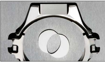
Auf einer Makino EDAF2 erodierpolierte Kavität für das Spritzen von Uhrengehäusen.
