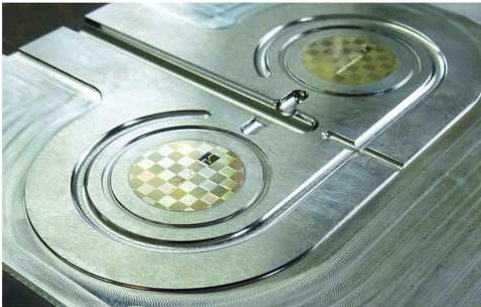
Leonhardt bietet das Fräsen von oberflächenintegrierten Hologrammen als prozessintegrierte Methode für Spritzgießwerkzeuge an.
